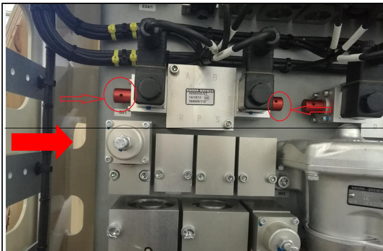
图 63 - 驻车制动器紧急断开按钮在制动装置柜上的布置
