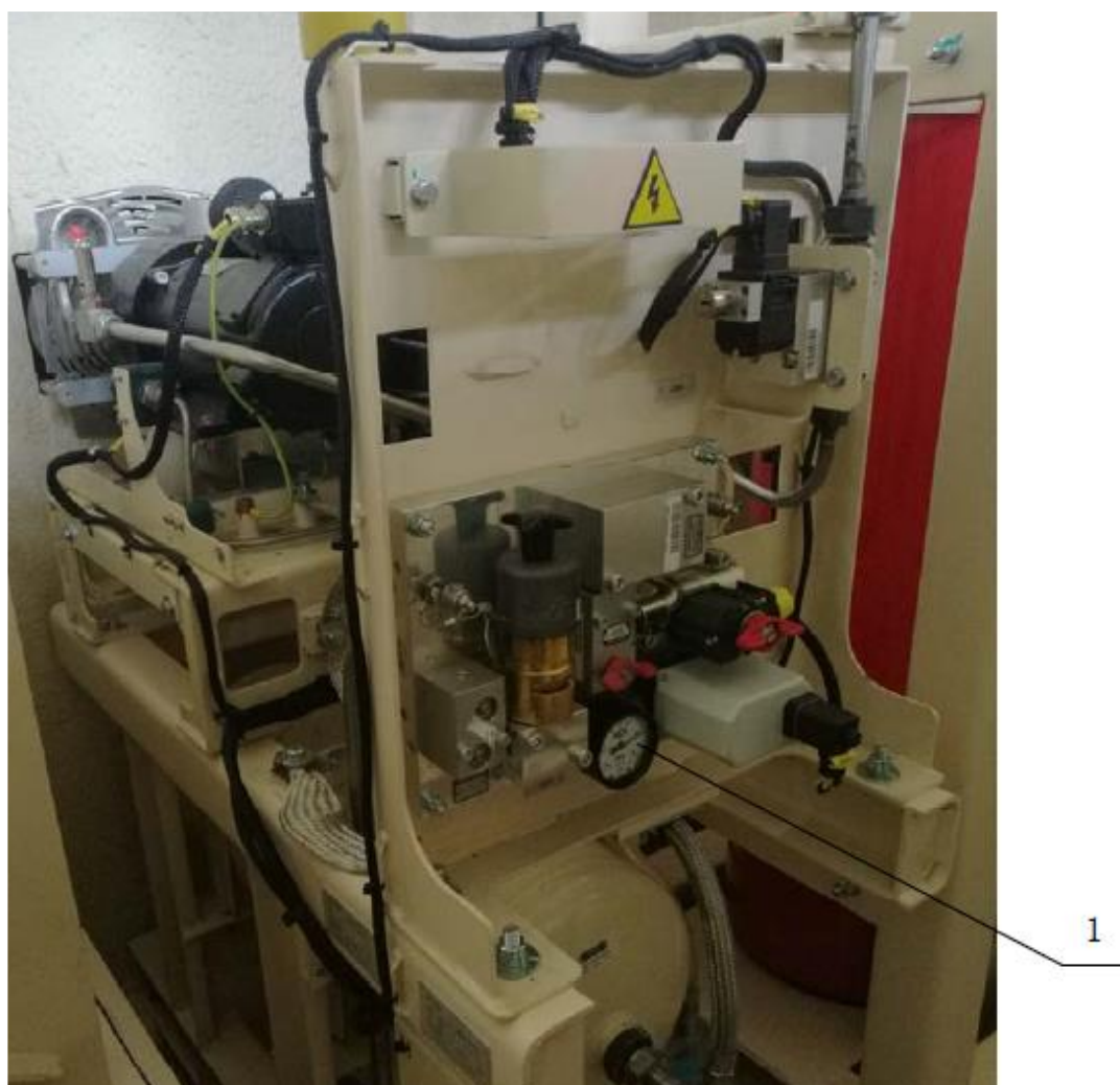
Рисунок 23 – Расположение манометра на панели вспомогательной компрессорной установки
