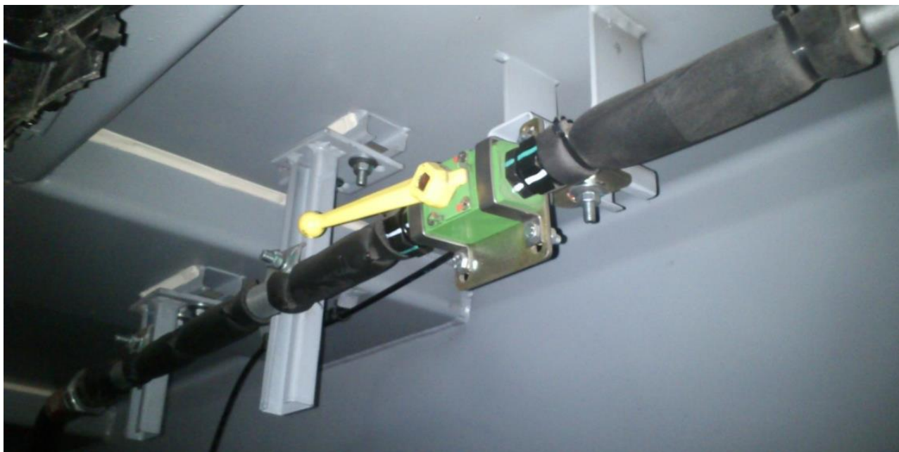
Рисунок 62 – Кран подачи воздуха в пневматический контур токоприемника
