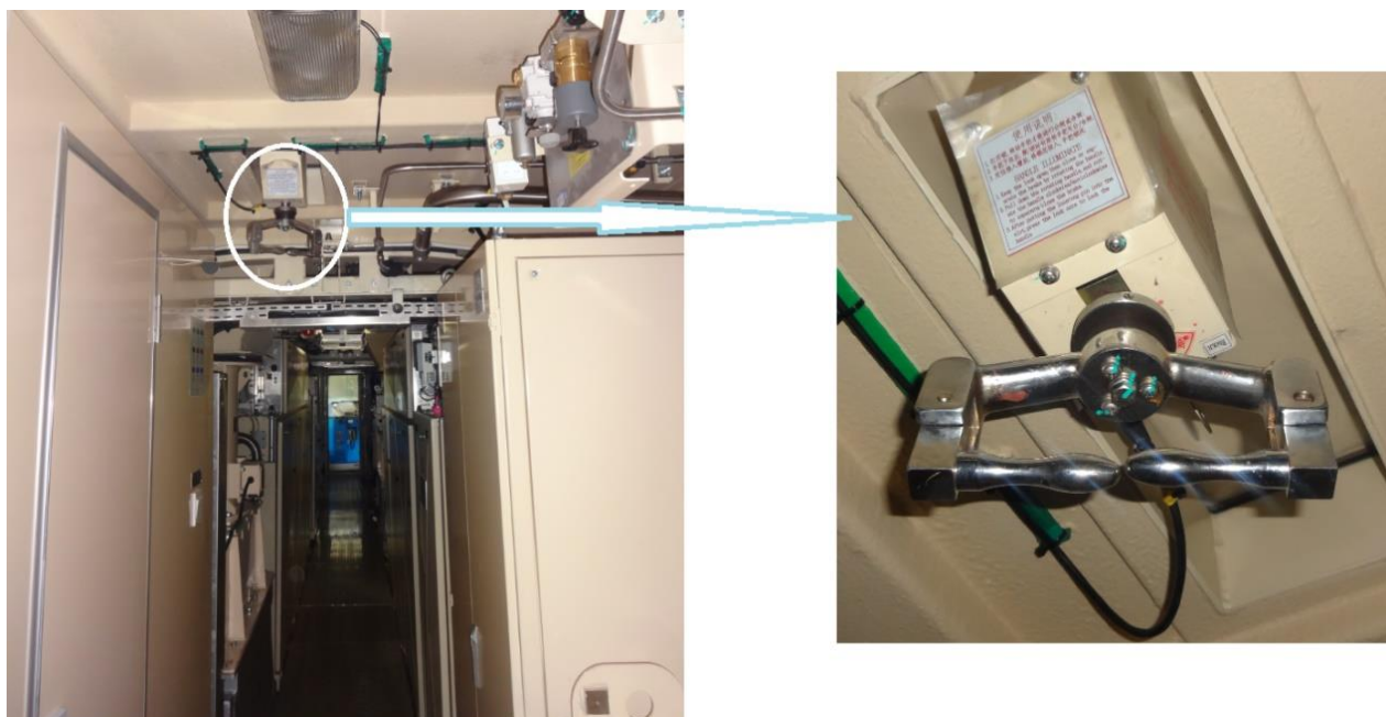
Рисунок 15 – Расположение высоковольтного разъединителя QS-HV (on – включен, off – выключен)
