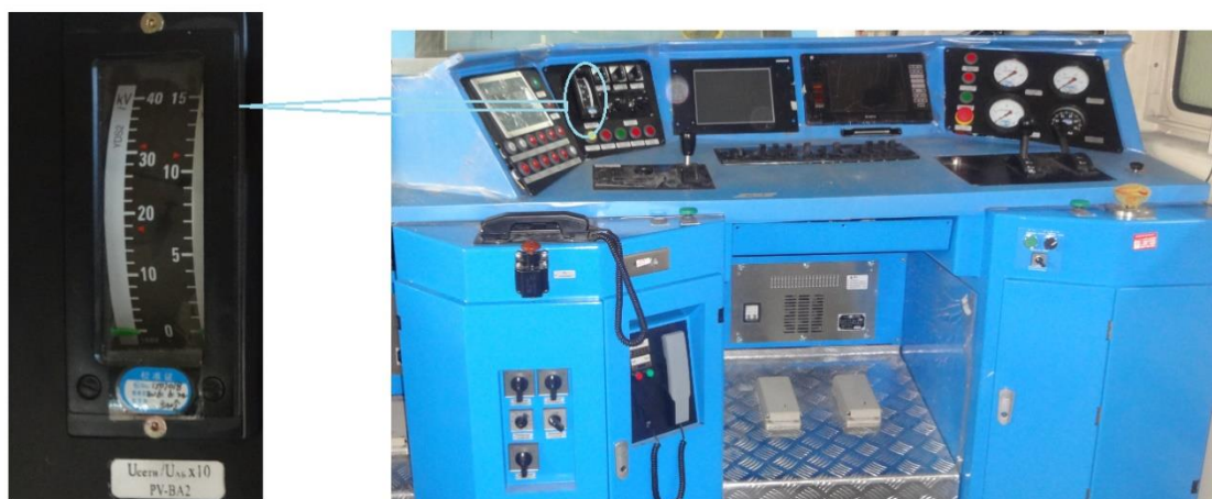
Рисунок 19 – Расположение двустрелочного вольтметра «PV-BA2» управления сетевым напряжением на пульте управления машиниста
