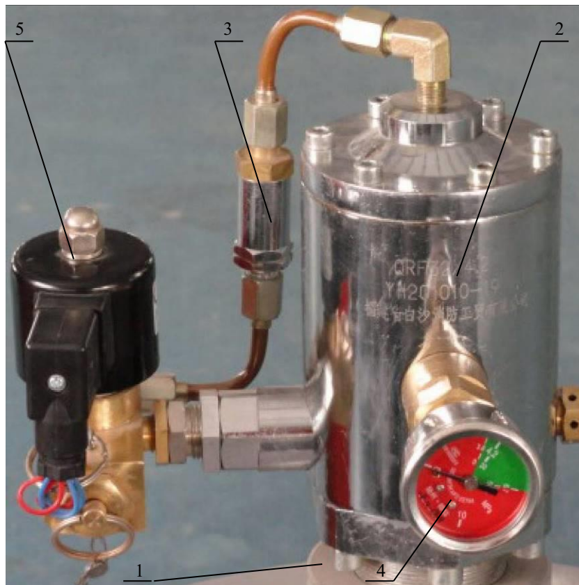
Рисунок 12.3 – Блок системы пожаротушения:
