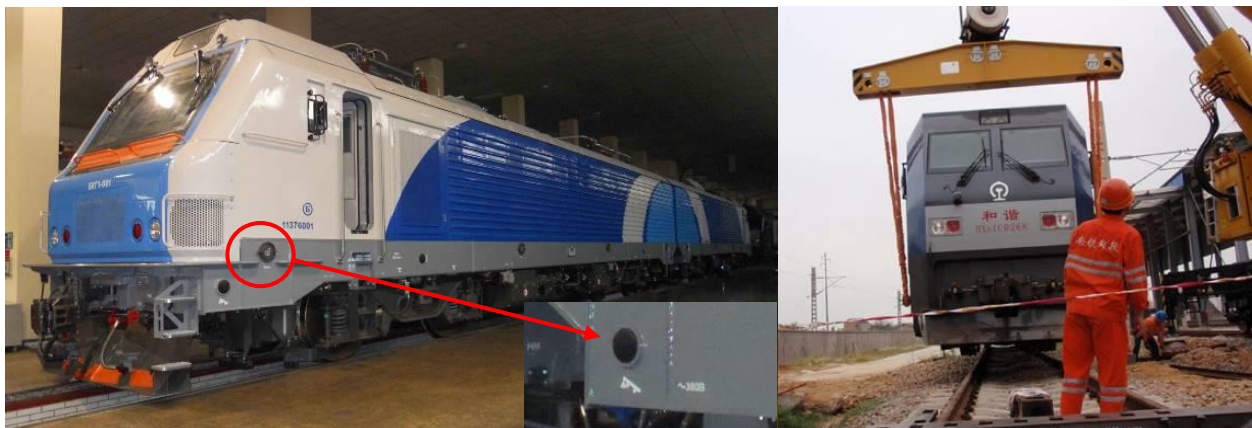
Рисунок 21.5 – Место установки кронштейна для подъема секции электровоза с одного конца
