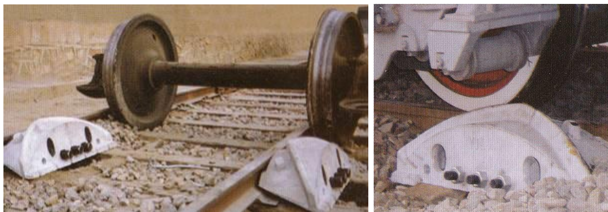
Рисунок 21.7 – Установка накаточных башмаков для возврата колесной пары в рельсовую колею
